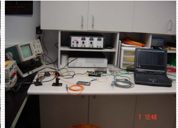
Comunicación por fibra óptica: sistema educativo y de evaluación Fast Ethernet
