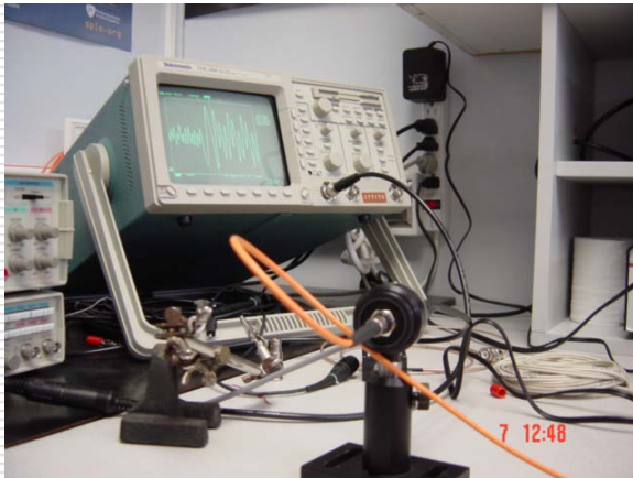
Ajuste de medición en fibra óptica y fotodetector rápido
