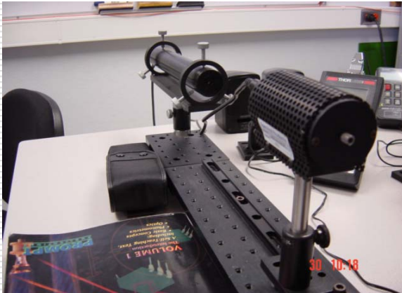
Montaje para Fotometría: fuente QTH y alineado con Láser
