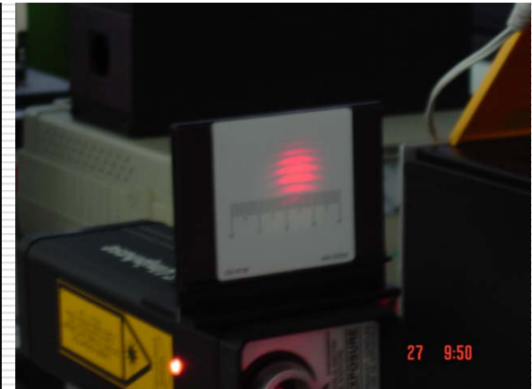
Patrones de interferencia de doble ranura con haz incoherente y coherente
